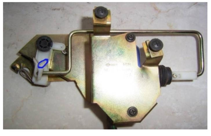
Für den elektr. Stellmotor muss ein Loch in das Blech. Grob angezeichnet bohrt man der Linie entlang und entfernt die Stege zwischen den Bohr-löcher mit der Feile. Für das Finish kommt ebenfalls die Feile zum Einsatz. Der Besitzer eines Dremels ist hier klar im Vorteil \* grins\*
