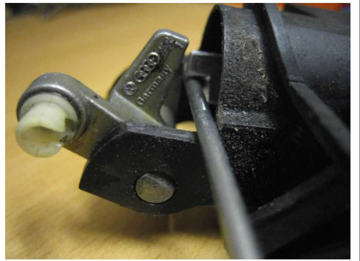
Auf diesem Bild sieht man die Ausklinkung am Bolzen und dem Gehäuse.
