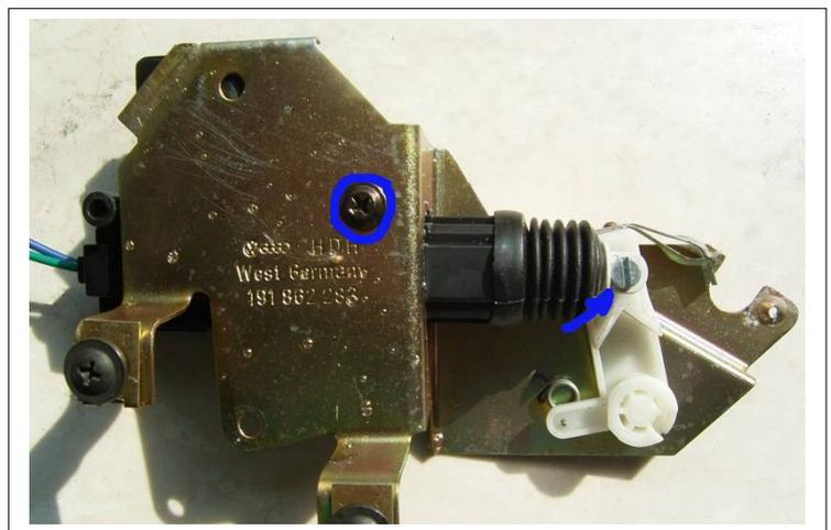
Für die Befestigung des Stellmotors muss noch ein Loch gebohrt werden.
