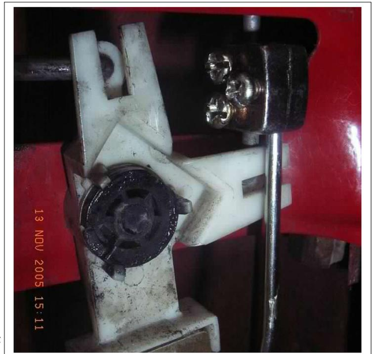
Als Alternative könnte ich mir auch vorstellen, die Zugstange am Sicherungshebel genau so zu befestigen, wie an den Vordertüren.
